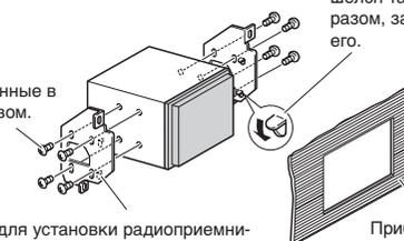
Кронштейн для установки радиоприемника, предусмотренный производителем
