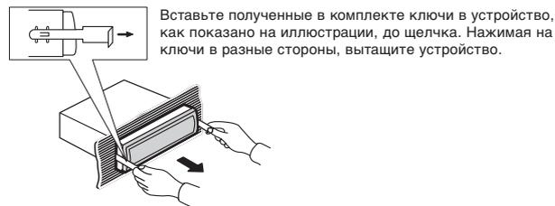
Вставьте полученные в комплекте ключи в устройство, как показано на иллюстрации, до щелчка. Нажимая на ключи в разные стороны, вытаскивайте устройство.
